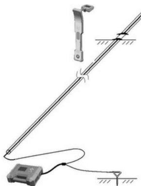
Figura 8.13 Cableado de prueba de fallas de rotura
